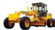
Engins de réglage à déplacement alternatif (niveleuse)
